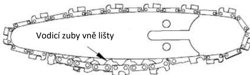
Uchopte zub uprostřed vodící lišty a vytáhněte jej směrem dolů. Pokud se obnaží celkem 3 zuby, je řetěz správně napnutý. Podle situace řetěz buď dotáhněte nebo povolte.
