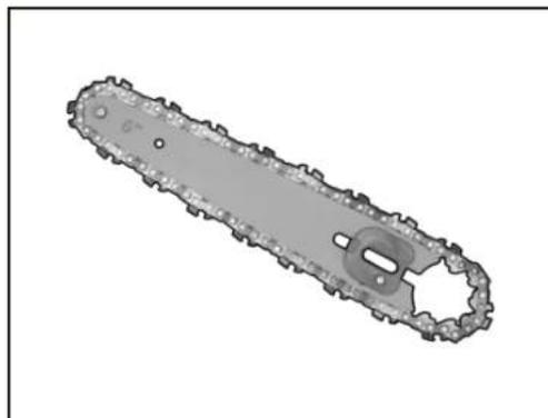
2. Vyměňte vodící lištu a vyměňte řetěz. Zarovnejte vnitřní články řetězu do drážky vodící desky.
