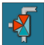
3cestný odkláněcí ventil (ukazující otevřenou a zavřenou trubku)
