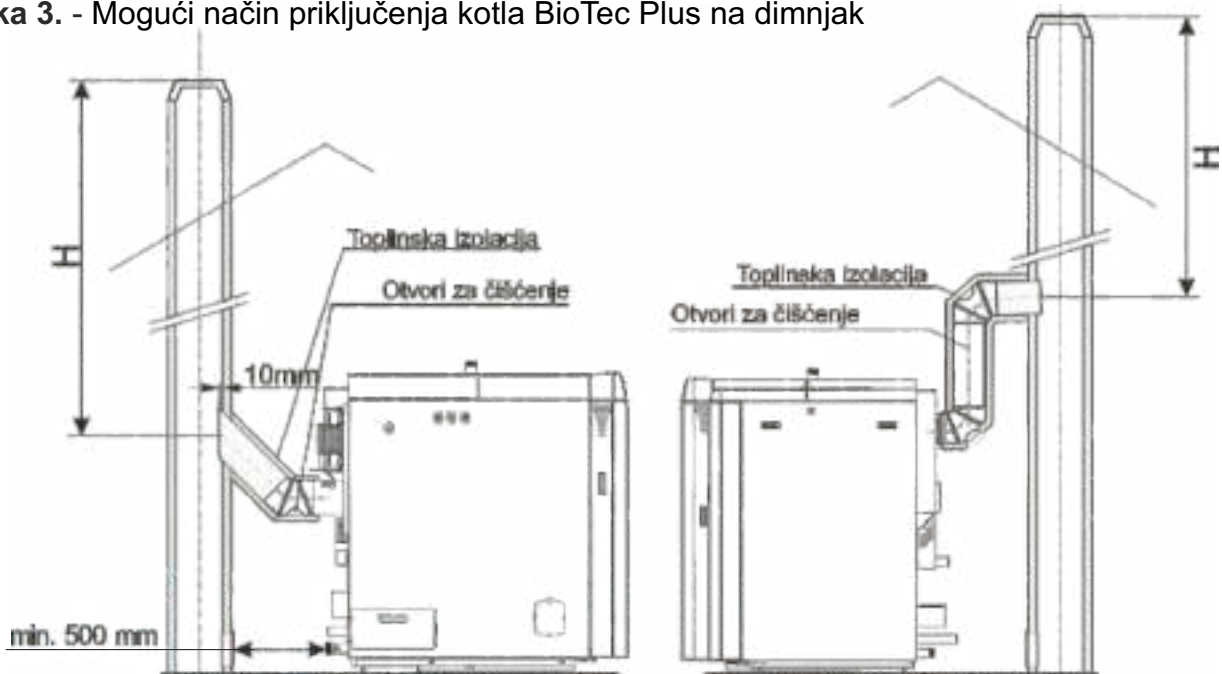
Slika 3. - Mogući način priključenja kotla BioTec Plus na dimnjak
