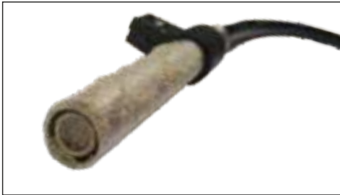
Prljava fotočelija koja može prouzročiti grešku u potpali ili grešku nestanka plamena
