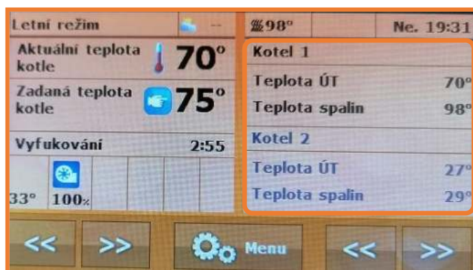
Teplota spalin na obou kotlích zobrazená na úvodní obrazovce displeje.
