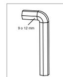
Našroubování se provádí pomocí speciálního klíče R73 (9 mm nebo 12 mm podle použitého typu).
